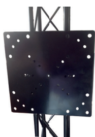
STAFFA per MONITOR in alluminio max 42", interasse 20x20 Componente n° 4053 Materiale: alluminio Peso: 1,500 Kg
