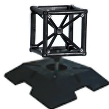
BASE PESANTE REGOLABILE con CUBO Componente n° 4025 Materiale: composito alluminio e plastica Peso: 26,000 Kg
